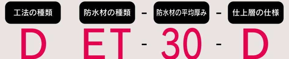
■工法の種類 D=絶縁工法 (D:MFテクノシートP, DB:MFテクノシートB)
